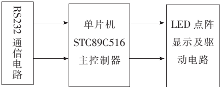
图 1 通信及控制显示电路
